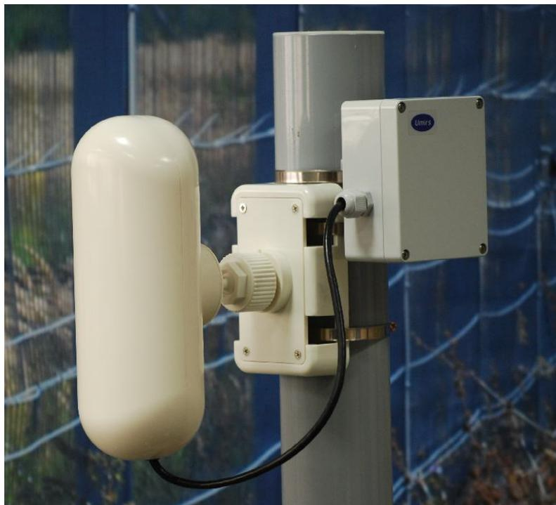
Рисунок 1.2 – Установка ПРМ (ПРД) и КР на стойке
