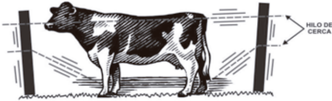
Ejemplo de cerca mal instalada
